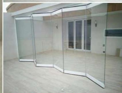
Il sistema Folding è un sistema a libro caratterizzato da fascioni in alluminio anodizzato argento. FOLDING LATERAL permette di decidere se assegnare internamente o esternamente l'ingombro delle ante impacchettate. Per garantire la massima semplicità di movimentazione è prevista una guida a terra incassata.
