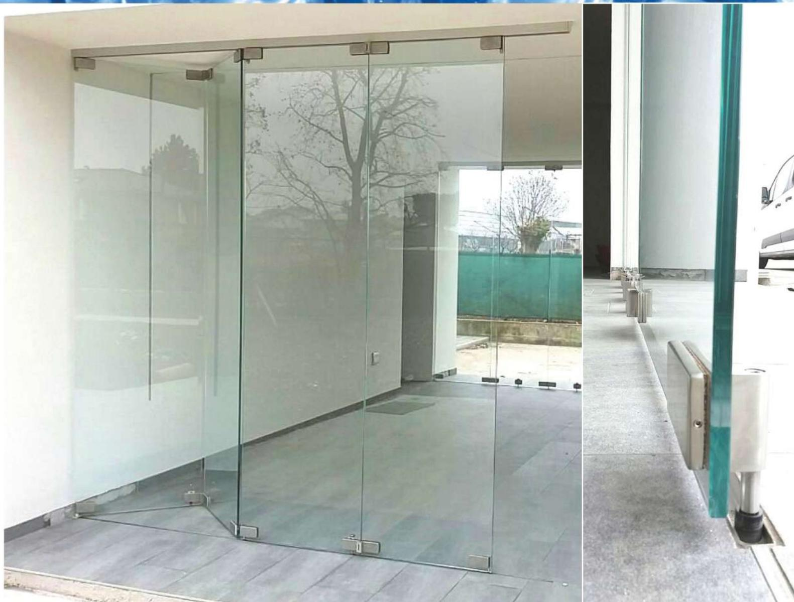
LIBRA INOX è un sistema a libro caratterizzato cerniere in acciaio inox. Le ante hanno una movimentazione sincronizzata ed è possibile decidere se assegnare internamente o esternamente l'ingombro delle ante impacchettate. Per garantire la semplicità di movimentazione è prevista una guida a terra incassata.
